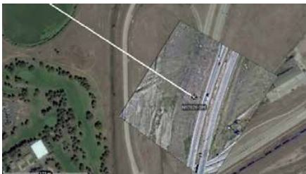
(a) การฉายกรอบพื้นที่มองเห็นของกล้อง (Sensor Footprint)
